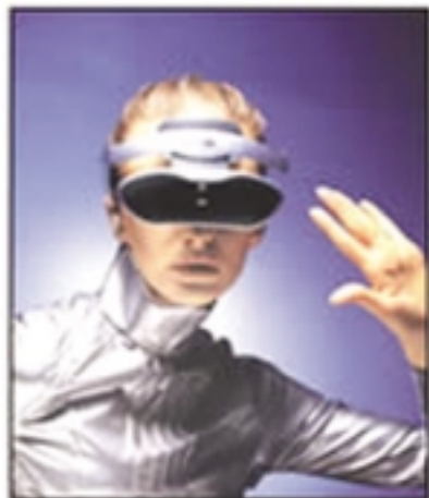
Imatge 3. Dispositiu de visualització anomenat Head Mounted Display
